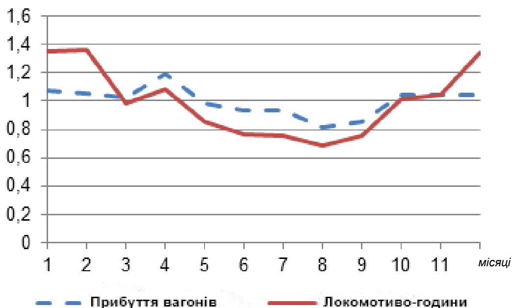
Рисунок 3.8 – Прогнозні помісячні зміни обсягів прибуття вагонів під вивантаження і локомотиво-години, що витрачаються на маневрову роботу (нормовані дані)
