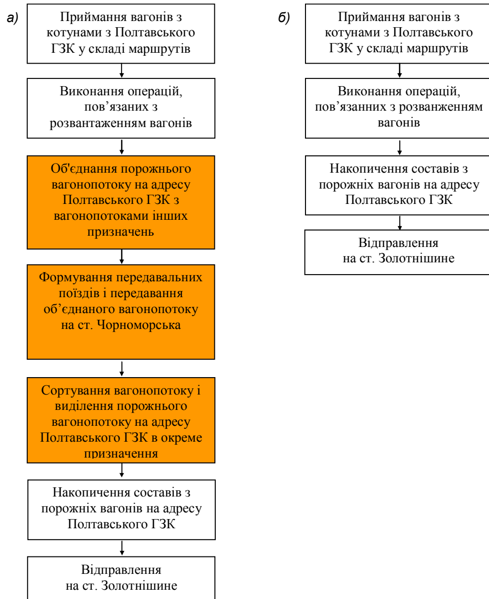
Рисунок 4.1 – Операції, що виконуються з вагонами Полтавського ГЗК на ст. Хімічна та ст. Чорноморська
