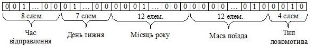
Рисунок 5 – Приклад кодування вхідного вектора фактичних даних про поїзд
