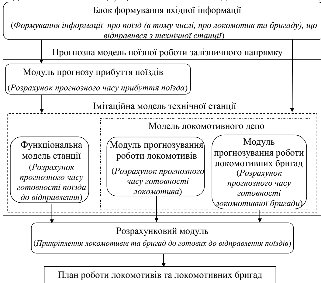
Рисунок 4 – Структура адаптивної моделі оперативного керування роботою локомотивного парку
