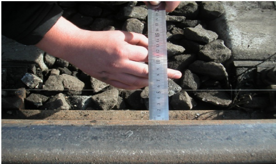
Рисунок 3.2 – Відлік стріли вигину
