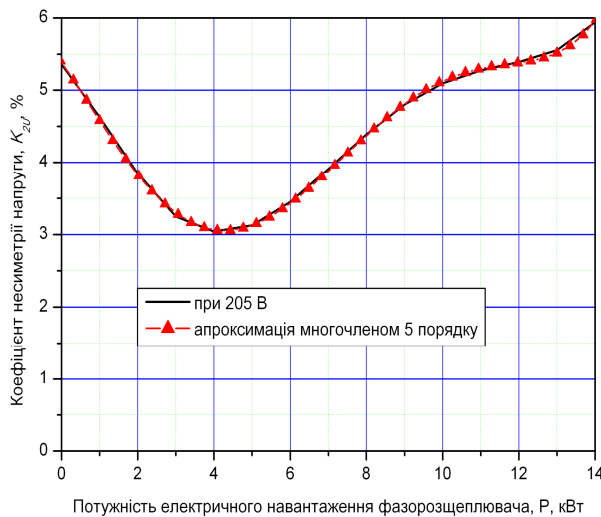
Рис. 2.6. Поліноміальна апроксимація залежності K_{2U} = f(P) при 205 В
