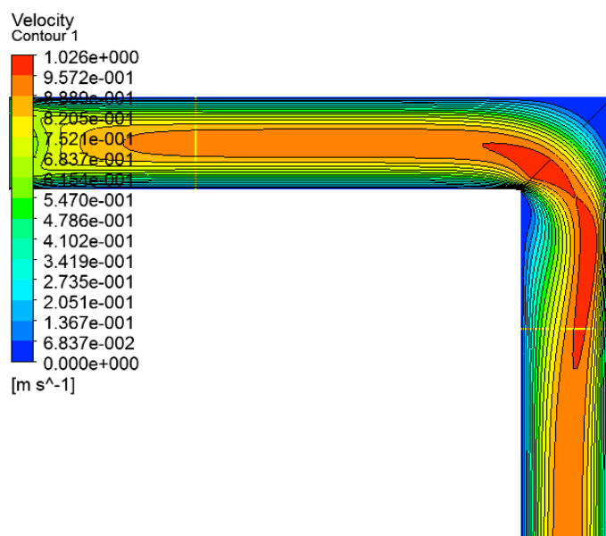
Рисунок 2.30 – Розподіл швидкостей течії водовугільного палива під час повороту на 90^\circ з радіусом скруглення \bar{R} = 0 , Re=30
