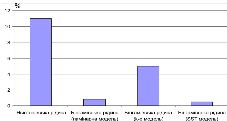
Рисунок 2.24 – Порівняння точності визначення втрат тиску за різними моделями
