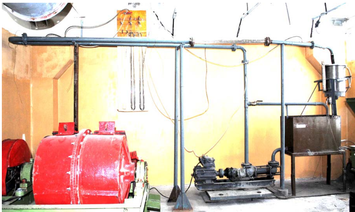
Рисунок 3.2 – Фотознімок експериментальної установки для дослідження реологічних і гідродинамічних характеристик транспортування ВВП
