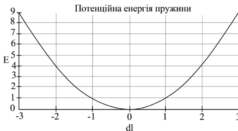
Рисунок 2.17 – Характер зміни потенційної енергії пружини
