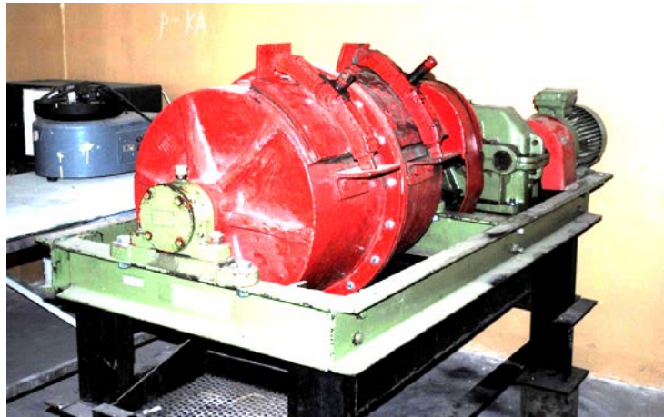
Рисунок 2.4 – Кульовий млин тонкого помелу (МШЦ)
