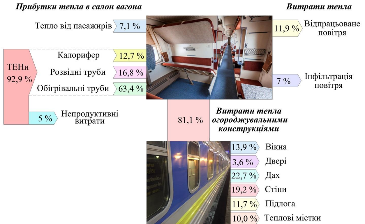
Рисунок 3.2 – Схема енергетичних потоків пасажирських вагонів
