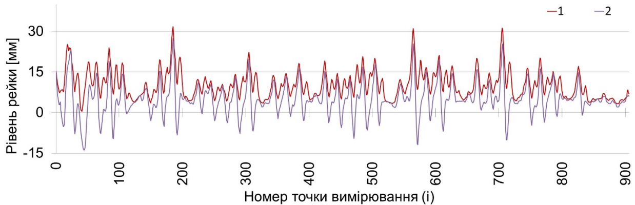
Рис. 5.15. Суміщений графік результатів вимірювань та розрахункового положення лівої рейки на обраній ділянці
