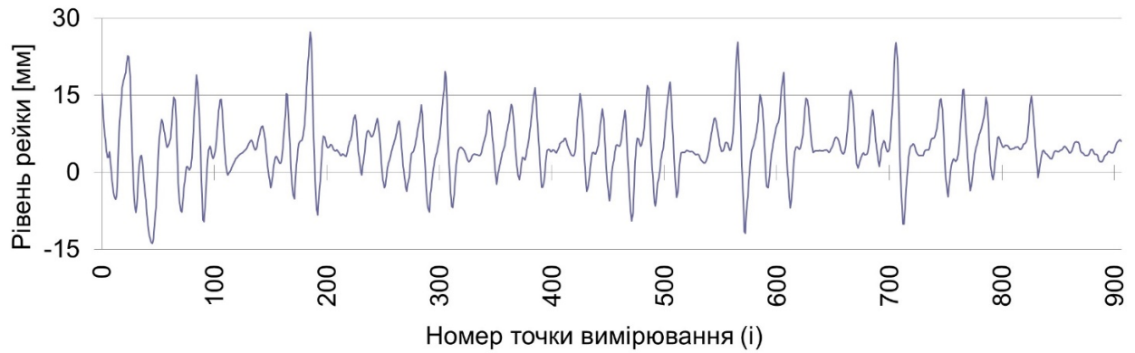
Рис. 5.12. Результати вимірювань машиною ВПР для лівої рейки
