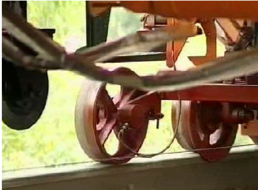
Рис. 5.7. Вимірювальне колесо контрольно-вимірювальної системи машини ВПР
