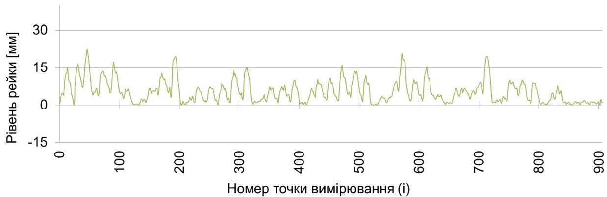
Рис. 5.16. Різниця між результатами вимірювань та розрахунками по лівій рейці
