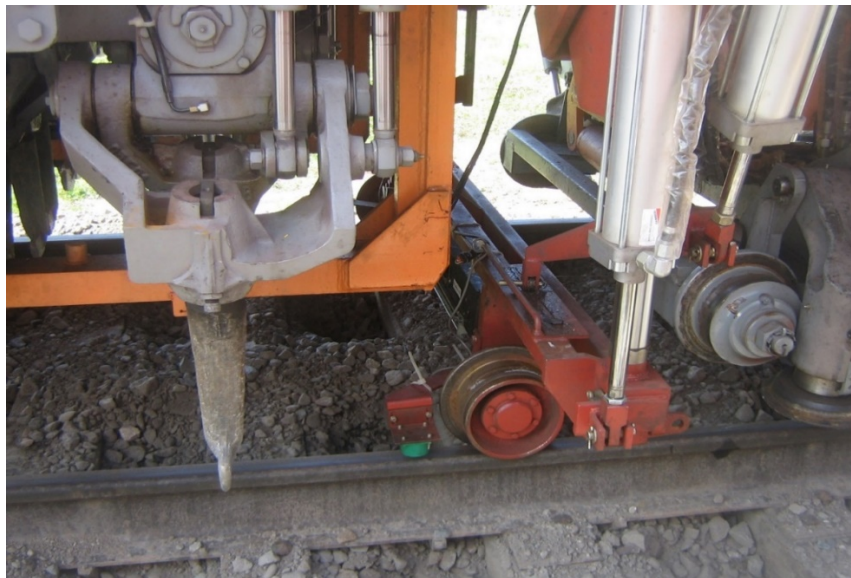
Рис. 5.4. Робочий візок контрольно-вимірювальної системи машини ВПР
