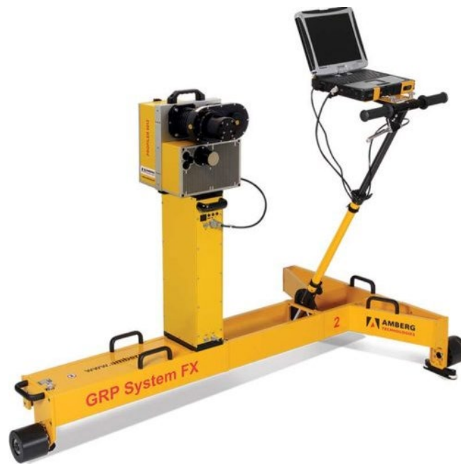
Рис. 2.14. Візок Amberg GRP обладнаний лазерним сканером
