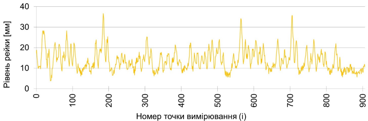
Рис. 5.17. Результати контрольних вимірювань машиною ВПР після виправки для лівої рейки
