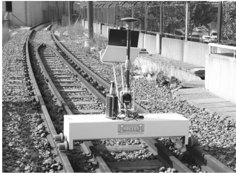
Рис. 2.10. Колієвимірювальний візок з встановленим GPS датчиком
