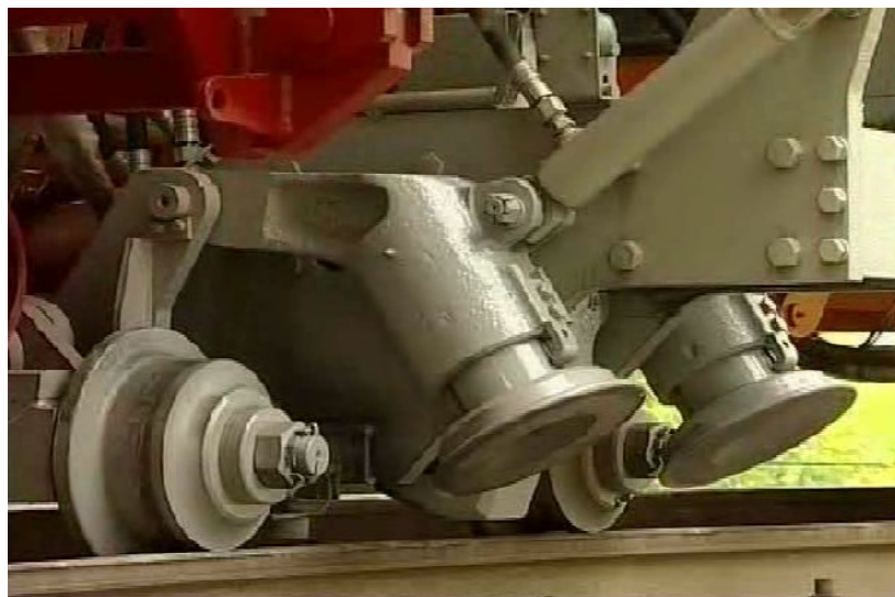
Рис. 5.8. Підйомно-рихтувальний пристрій (ПРП) системи виправки машини ВПР
