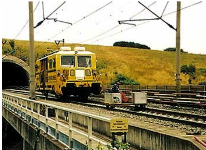
Рис. 2.20. Колієрихтувальна машина в створі двох лазерних візків
