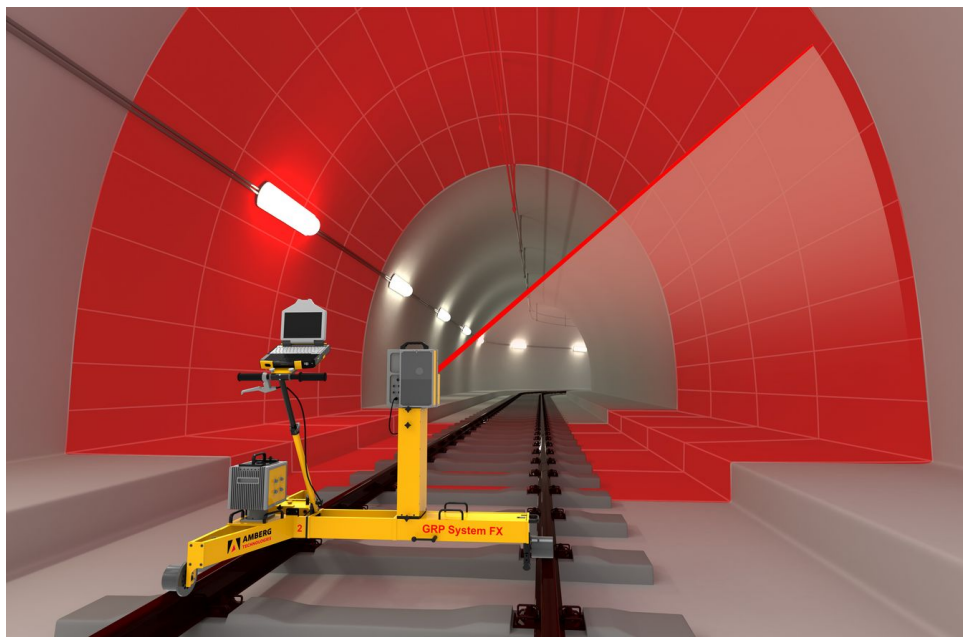
Рис. 2.15. Робота візка Amberg GRP обладнаного лазерним сканером
