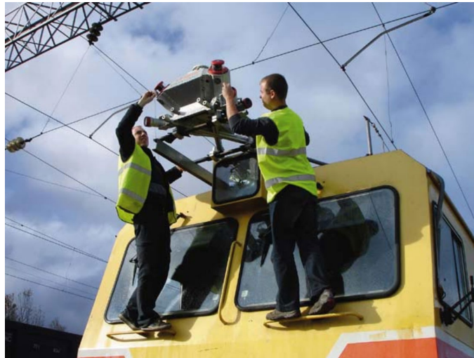
Рис. 2.16. Скануюча лазерна система встановлена на даху машини типу ВПР
