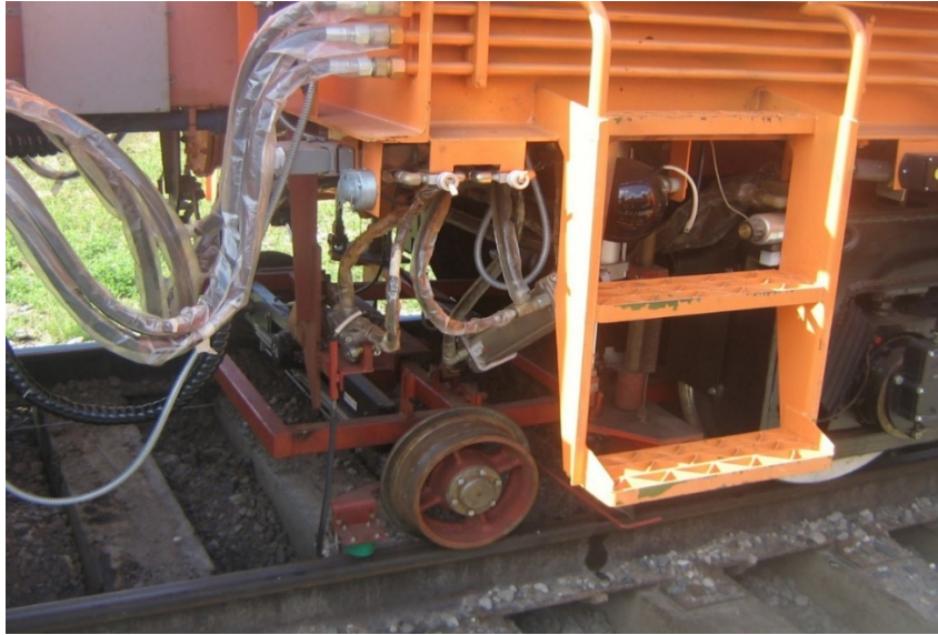
Рис. 5.5. Контрольний візок контрольно-вимірювальної системи машини ВПР
