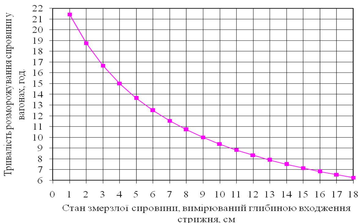
Рисунок 3.8 – Залежність тривалості розморожування сировини у вагонах від стану змерзлої сировини, вимірюваний глибиною входження стрижня
