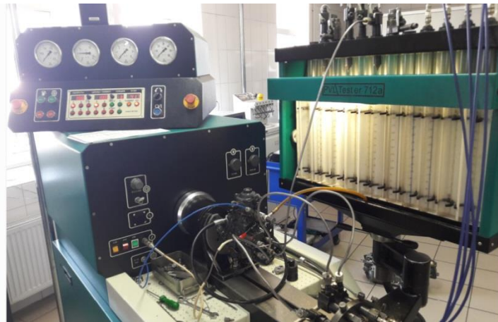
Рисунок 2.21 – Стенд для експериментальних досліджень експлуатаційних параметрів паливного насосу високого тиску та форсунок
