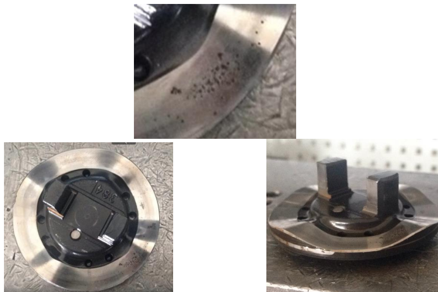
Рисунок 2.22 – Характерні пошкодження плунжерної шайби паливного насосу високого тиску
