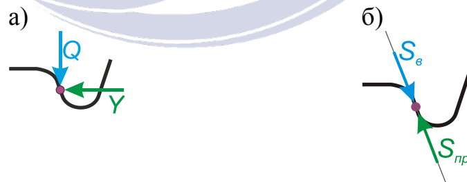
Рисунок 7 – Схема сил: а) у задачі Надаля; б), що повертають колесо вниз і перешкоджають ковзанню колеса вниз
