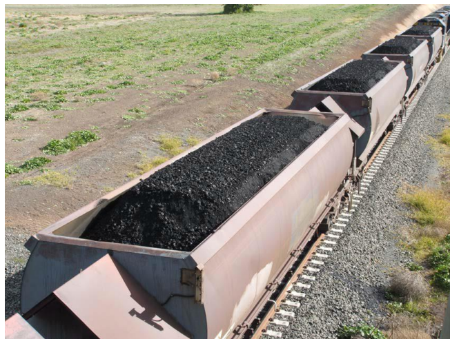
Рисунок 1.14 – Профілювання поверхні вантажу, поверхня типу «garden bed» (Австралія) [89]
