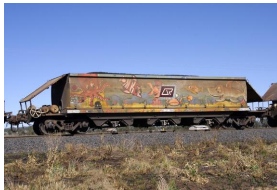
Рисунок 1.11 – Застосування похилих пластин у напіввагоні (Австралія)
