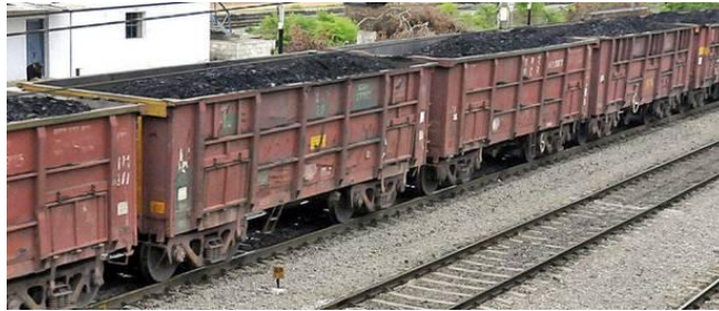
Рисунок 1.8 – Обмеження по висоті «шапки» вантажу ( «шапка» вантажу незначно перевищує висоту борту)
