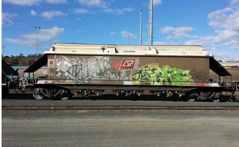
Рисунок 1.16 – Модернізований напіввагон для перевезення вугілля, на який встановлена кришка, Австралія (для порівняння див. рис. 1.11)
