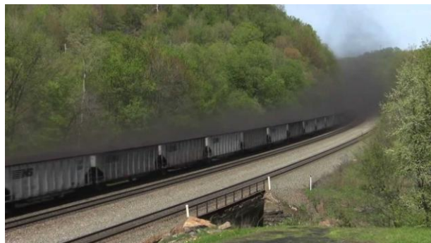
Рисунок 1.1 – Винос пилу з напіввагонів під час транспортування вугілля
