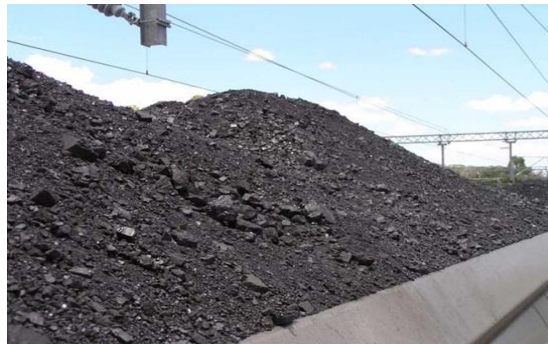
Рисунок 4.3 – «Шапка» вантажу перевищує висоту борту напіввагона [89]
