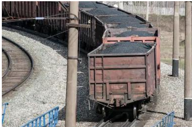
Рисунок 1.9 – Обмеження по висоті «шапки» вантажу ( «шапка» вантажу перевищує висоту бортів, але в межах рекомендацій)
