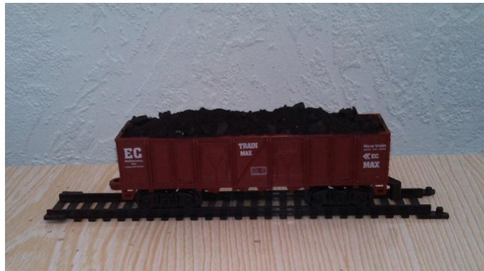
Рисунок 4.4 – Модель напіввагона з вугіллям (завантаження з «шапкою»)
