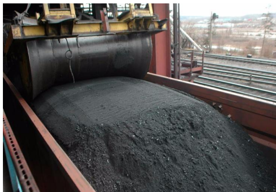
Рисунок 1.7 – Застосування спеціального котка для розрівнювання й ущільнення поверхні вантажу
