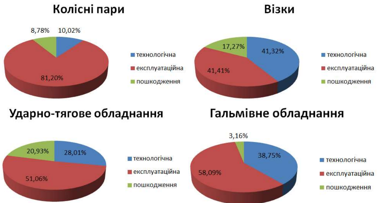
Рисунок 2.9 – Характер причин пошкодження візків вантажних вагонів
