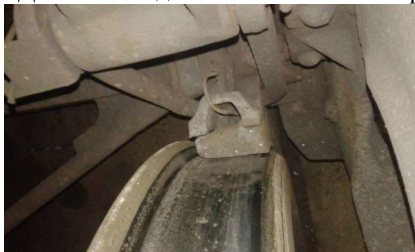
Рисунок Д.5 – Пошкодження автозчепного пристрою
