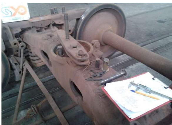
Рисунок Д.1 – Виконання ультразвукової товщинометрії несучих конструкцій кузова піввагона
