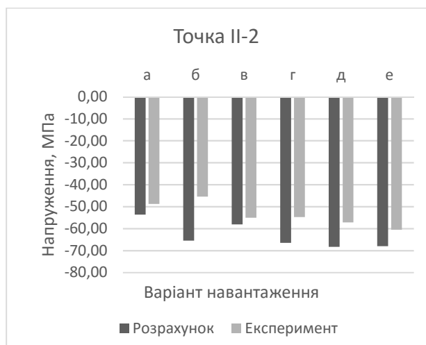
Рисунок 2.13 – Напруження в точці II-2 при різних варіантах навантаження
