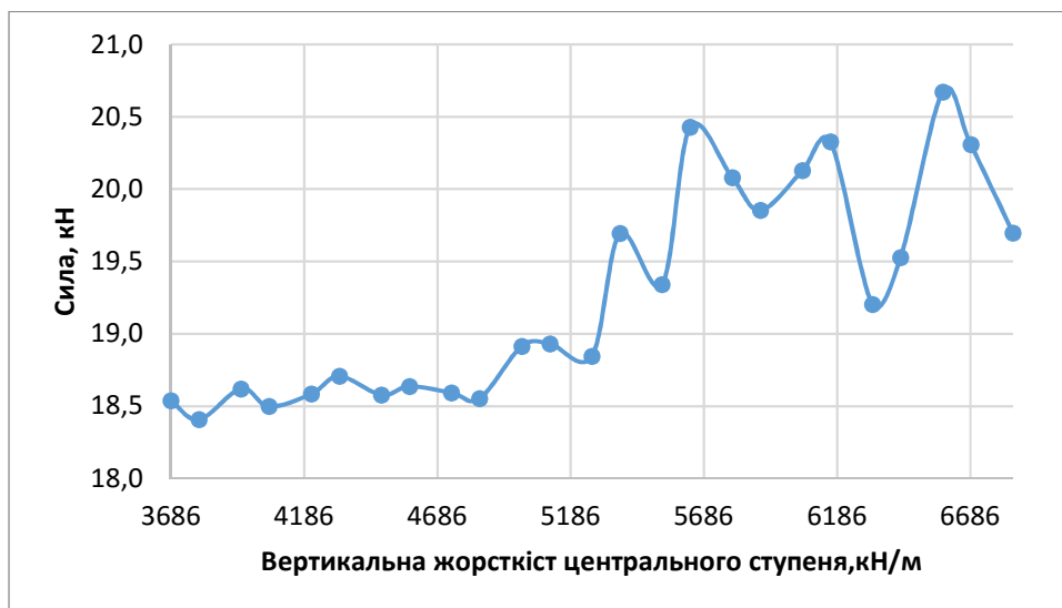
Рисунок 4.3 – Максимальна вертикальна сила в буксовому прорізі
