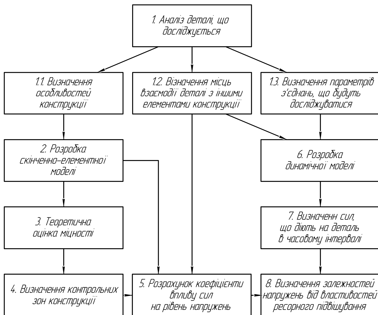
Рисунок 4.12 – Метод уточнення динамічного навантаження конструкції
