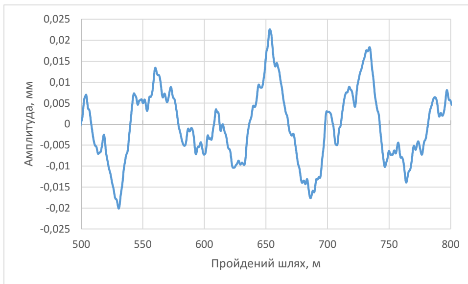
Рисунок 3.15 – Фрагмент нерівності рейок безстикової колії
