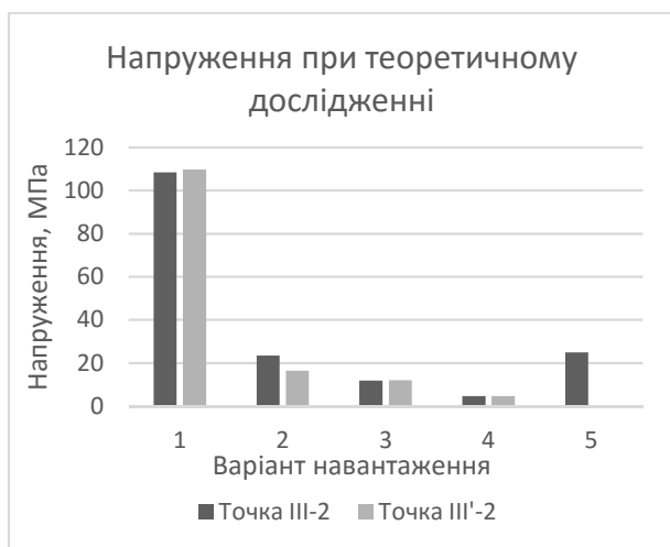
Рисунок 2.12 – Напруження в точках III-2 та III'-2 при теоретичному дослідженні
