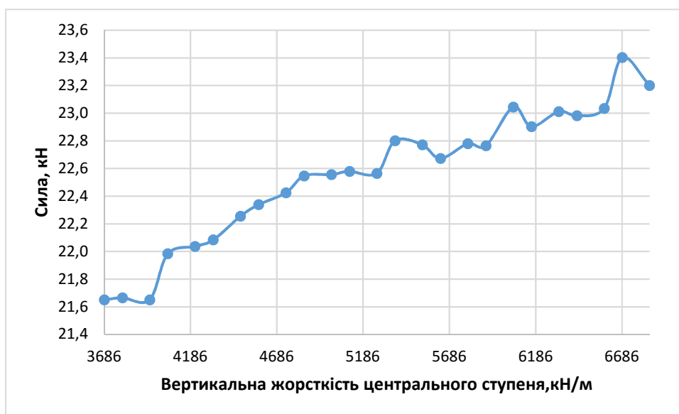
Рисунок 4.2 – Максимальна поперечна сила в центральному ресорному комплекті
