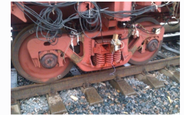
Ходовые, динамические и прочностные испытания полувагона с осевой испытательной нагрузкой 25 т/ось
