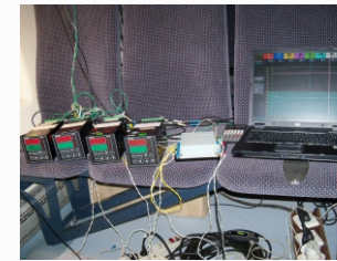
Измерительное оборудование для теплотехнических испытаний рельсового автобуса PESA (Польша)
