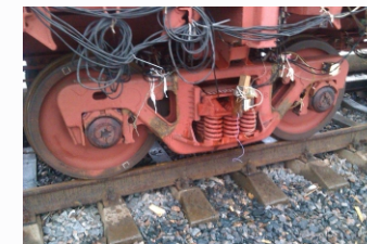
Ходовые, динамические и прочностные испытания полувагона с осевой испытательной нагрузкой 25 т/ось
