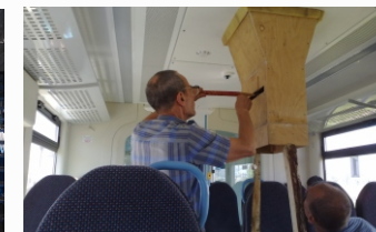
Определение расхода воздуха по салону рельсового автобуса PESA (Польша)
