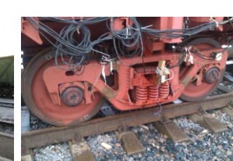
Ходовые, динамические и прочностные испытания полувагона с осевой нагрузкой 25 т/ось Running, dynamic and strength tests of open car (gondola wagon) with axial test load - 25 ton/axle
