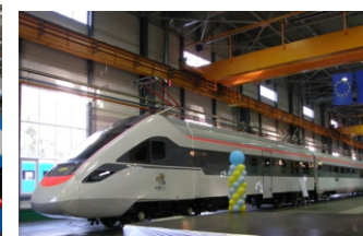
Двухсистемные электропоезда производства ПАО «Крюковский вагоностроительный завод» со скоростью до 200 км/ч Dual-system electric trains produced by JSC "Kriukov car building works" with speed 200 km/h
