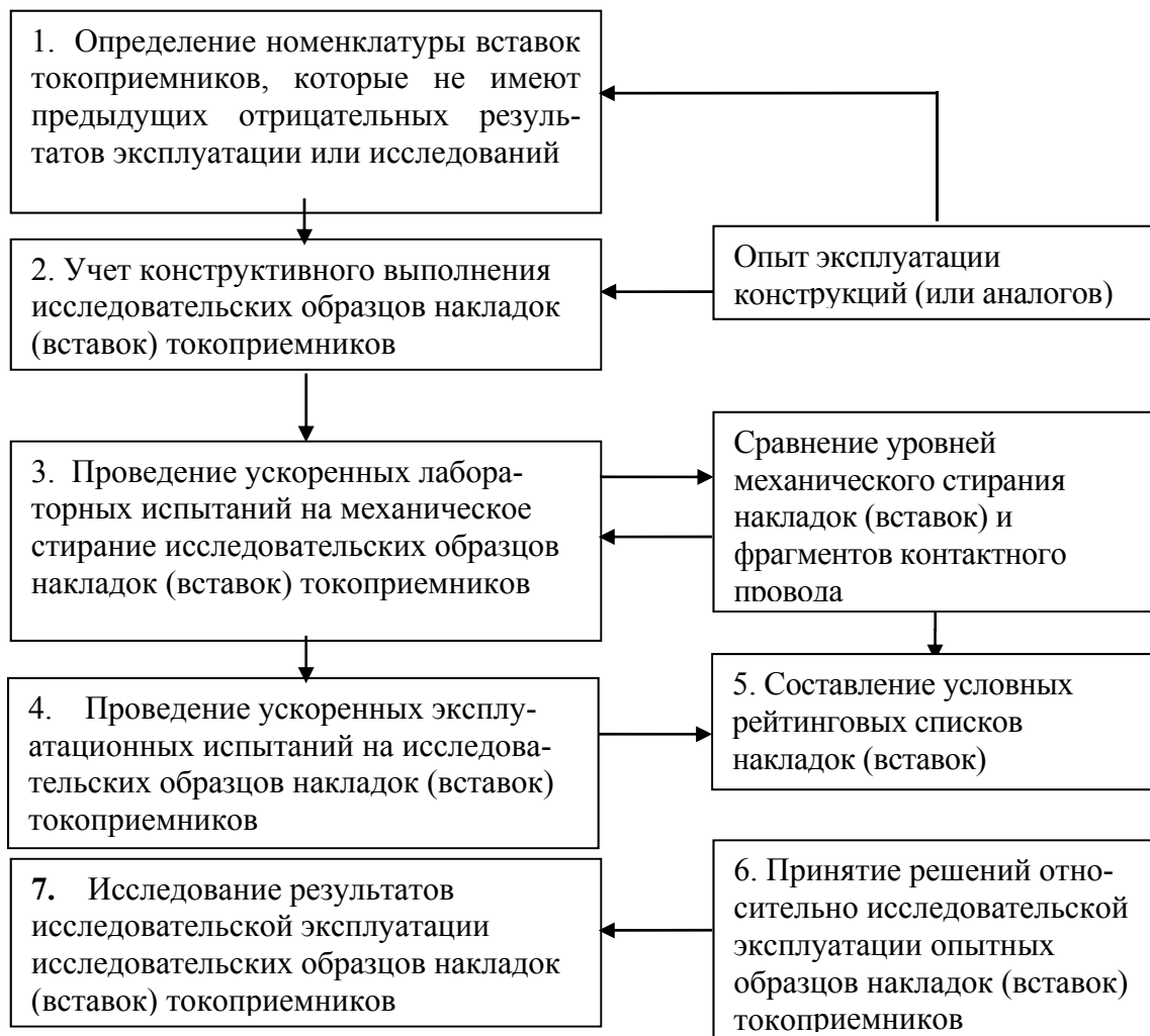
Рис. Методика сравнительной оценки качества накладок токоприемников
