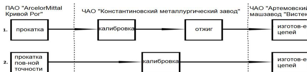
Рис. 1 Схемы производства цепей класса С из калиброванного металла
