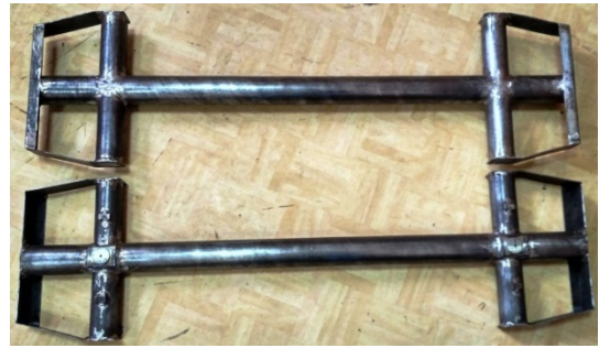
Рис. 2. Моделі рами вагона-цистерни реалізована в металі (1:10)
