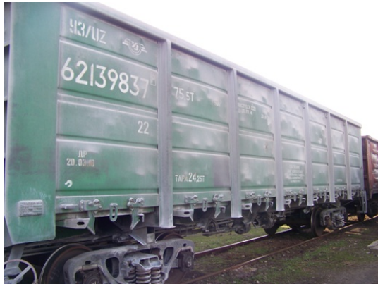
Рис.1 – Піввагон мод. 12-1905 на візках мод. 18-1711
