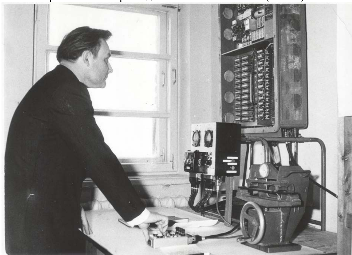
Исследование продольной динамики поезда на аналоговых устройствах.
