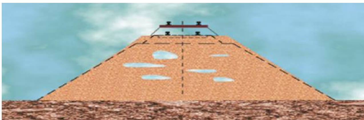
Рисунок 1.4 – Деформації і переміщення частинок ґрунту внаслідок дії вологи всередині земляного полотна
