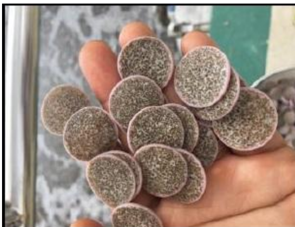
Рисунок 1.7 – Рухоме завантаження для біореактора [124]
