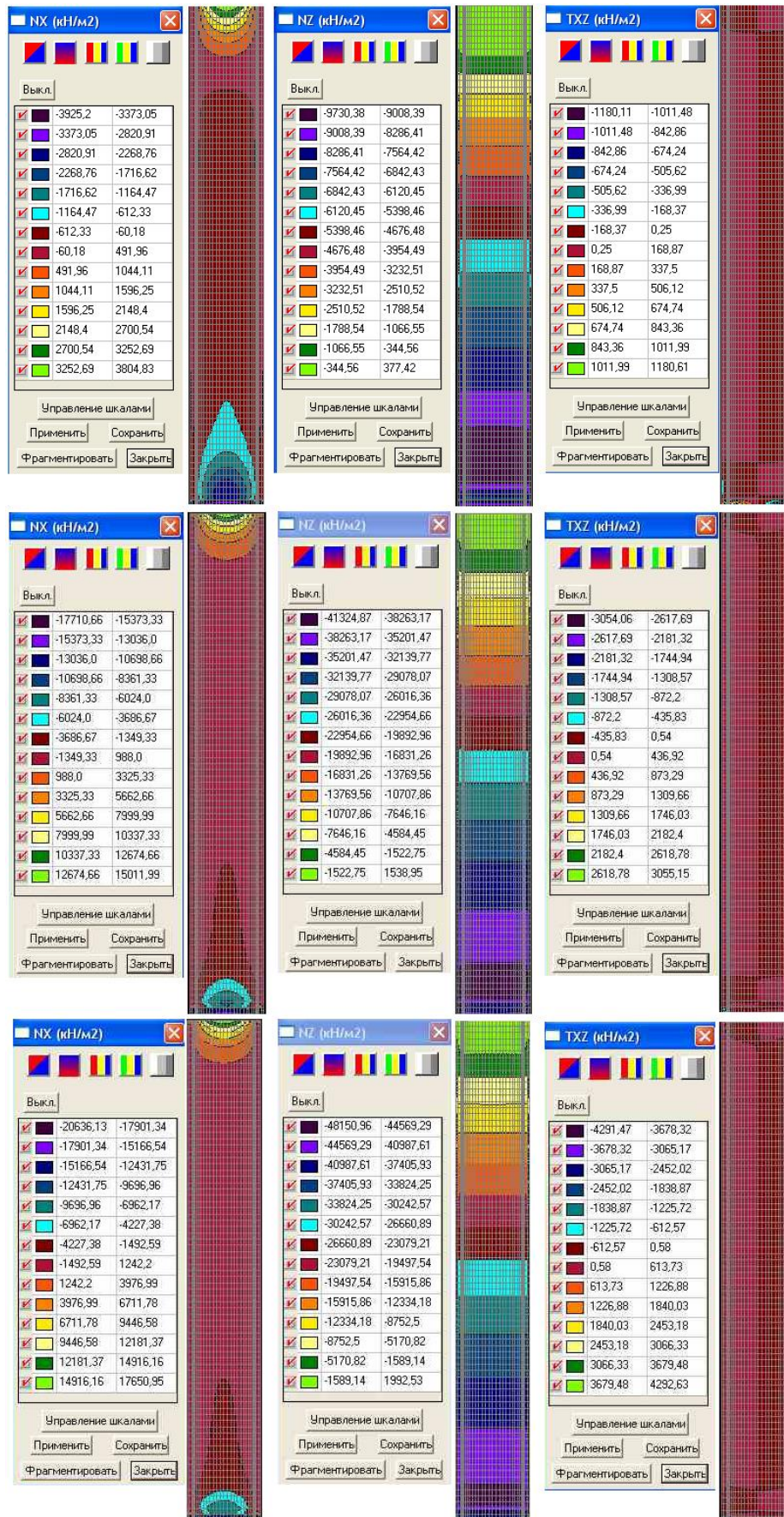
Рисунок 3.7 – Характерна картина ізолій та ізополів напруженого стану (грунтовий масив – пісок при температурі -6^{\circ}\text{C} )
