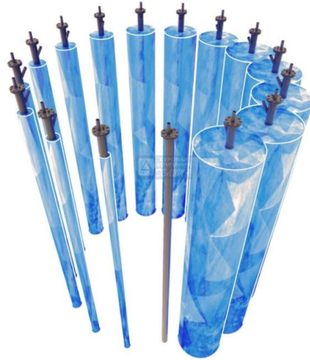
Рисунок 1.3 – Послідовність виникнення льодогрунтового кільця масиву навколо виробки
