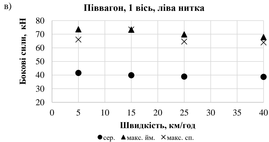
Рис. 4.14. Бокові сили від коліс, що набігають на рейку:
